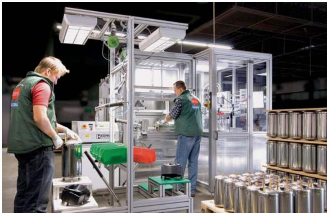
Die halbautomatische Siebdruckanlage ist mit Kühnast-UV-trocknung ausgestattet.
