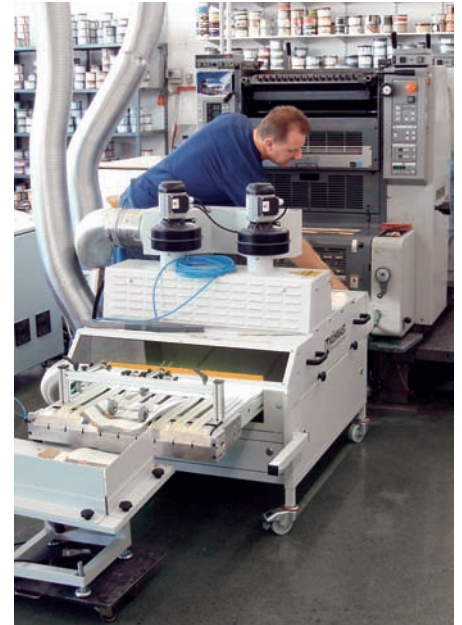
Der mobile UV-Quickstart-Bandtrockner kann ohne großen Aufwand an die Druckmaschine angeschlossen werden.
