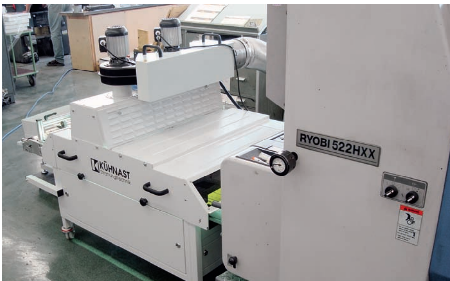
Eine Ryobi 522 HXX beim Einsatz mit einem Kühnast-UV-System mit Quickstart-Technologie.
