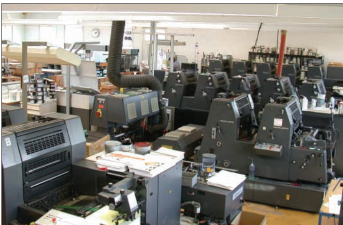
Herrmann Druck + Media: Mit insgesamt 15 Druckwerken (sieben UV, acht konventionell) im kompakten A3-Format ist ausreichend Kapazität vorhanden, um auch umfangreiche Projekte abzuwickeln.
