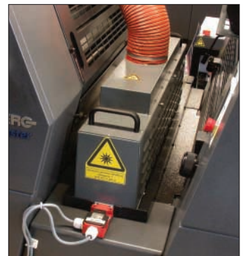
UV-Quickstart-Technologie für kurzen Ein-/Ausschalt-Wechsel und geringen Energieverbrauch.
