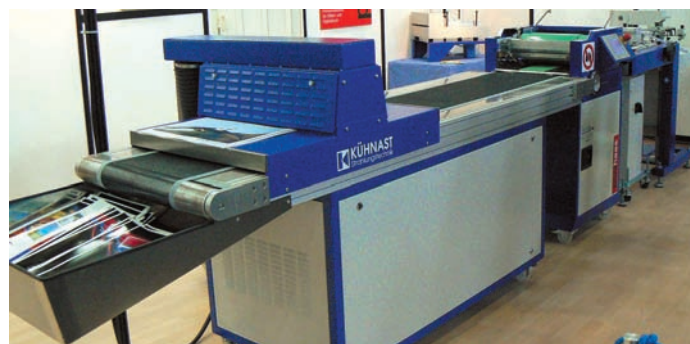
Haas-UV-Lackiermaschine LUV 400 mit Auslageverlängerung und Kühnast-UV-Quickstart-Trockner.
