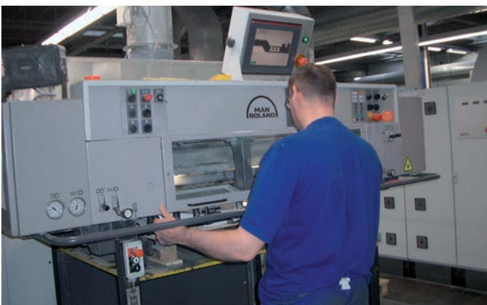
Die Roland 706 LV wurde mit einem UV-Quickstart-System von Kühnast Strahlungstechnik ausgerüstet. Mit dem neuen UV-System liegt die Steigerung der Produktivität, je nach Auftragsstruktur, zwischen 25 und 40 %.
